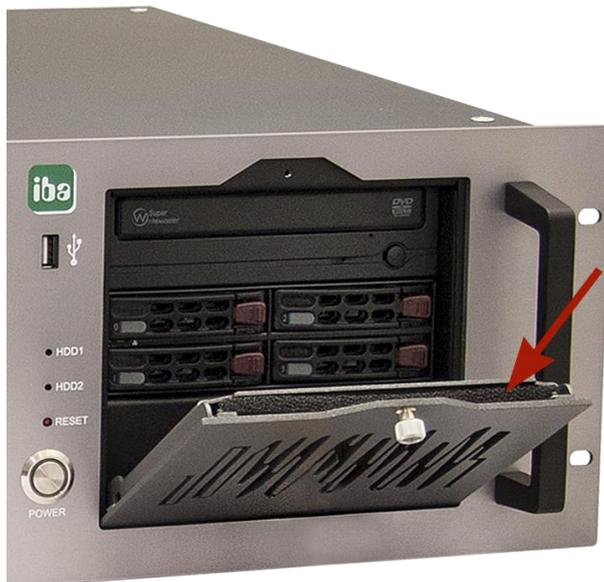
2. Nehmen Sie den Staubfilter aus dem Gitter.
