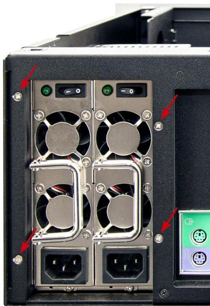
3. Lösen Sie die beiden Schrauben innen, mit welchen das Netzteil am Gehäuse innen befestigt ist.
