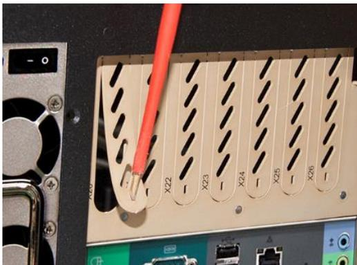
3. Über dem Steckplatz befindet sich in der Öffnung eine Schraube, mit der die Karte später befestigt wird. Lösen Sie die Schraube und nehmen Sie sie heraus.
